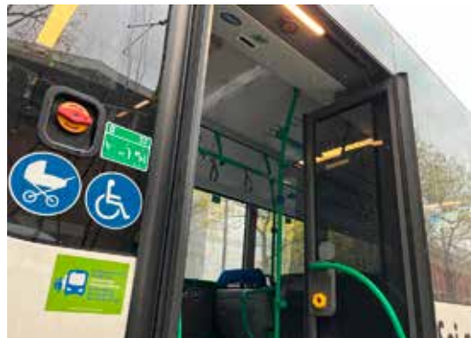
Eingangsbereich MVV-RegionalBus mit Sensor und Hinweis zur automatischen Fahrgastzählung. Der Bordrechner sammelt die Zählwerte und überträgt sie an einen Server.
